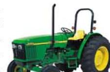
يوجد بهذا الجرار المواصفات الفنية الآتية: محرك تربيني ذو 4 اسطوانات بقوة 75 حصان، فصل ثالثي، 9 × 9 ممتدوى سرعات، سلحفاة القراءة 540 (勒/دقيقة)، رافع أدوات هيدروليكي صنف رقم 2 حتى وزن 2670 كجم، بشنجل هيدروليكي بمضخة وصلة رفع سعة 43 لتر/دقيقة، عجلة قبالة هيدروليكي، صمام تحكم هيدروليكي، 7.5 × 16 إطارات أصلية، 16.9 × 30 إطارات خفيفة، هيكل روبيس (ROPS) لتزويد الوفلة أثناء الانقلاب، مطلة وافية وأنفل الموارد الأمامية.
