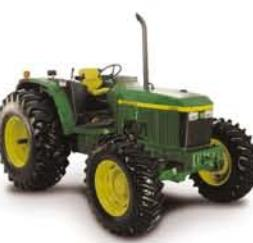
يوجد بهذا الجرار المواصفات الفنية الآتية: محرك تربيني ذو 4 اسطوانات بقوة 106 حصان، فصل ثالثي، 12 × 4 ممتدوى سرعات، سلحفاة القراءة 540 (勒/دقيقة)، رافع أدوات هيدروليكي صنف رقم 2 حتى وزن 2670 كجم، بشنجل هيدروليكي بمضخة وصلة رفع سعة 80 لتر/دقيقة، عجلة قبالة هيدروليكي، صمام تحكم هيدروليكي، روبيس (ROPS) لتزويد الوفلة أثناء الانقلاب، عرفة قبالة خفيفة، هيكل 11.2 × 28 إطارات أصلية، 13.6 × 38 إطارات خفيفة، الأختبلات تشمل الإطارات، عرفة قبالة مكففة و 16 × 18 ممتدوى سرعات.
