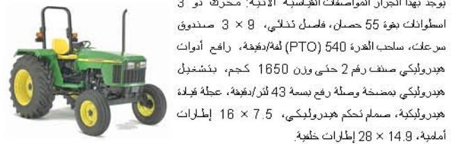
يوجد بهذا الجرار المواصفات الفنية الآتية: محرك تربيني ذو 3 اسطوانات بقوة 55 حصان، فصل ثالثي، 9 × 9 ممتدوى سرعات، سلحفاة، سلحفاة القراءة 540 (勒/دقيقة)، رافع أدوات هيدروليكي صنف رقم 2 حتى وزن 1850 كجم، بشنجل هيدروليكي بمضخة وصلة رفع سعة 43 لتر/دقيقة، عجلة قبالة هيدروليكي، صمام تحكم هيدروليكي، 7.5 × 16 إطارات، أمثلية، 14.9 × 28 إطارات خفيفة.
